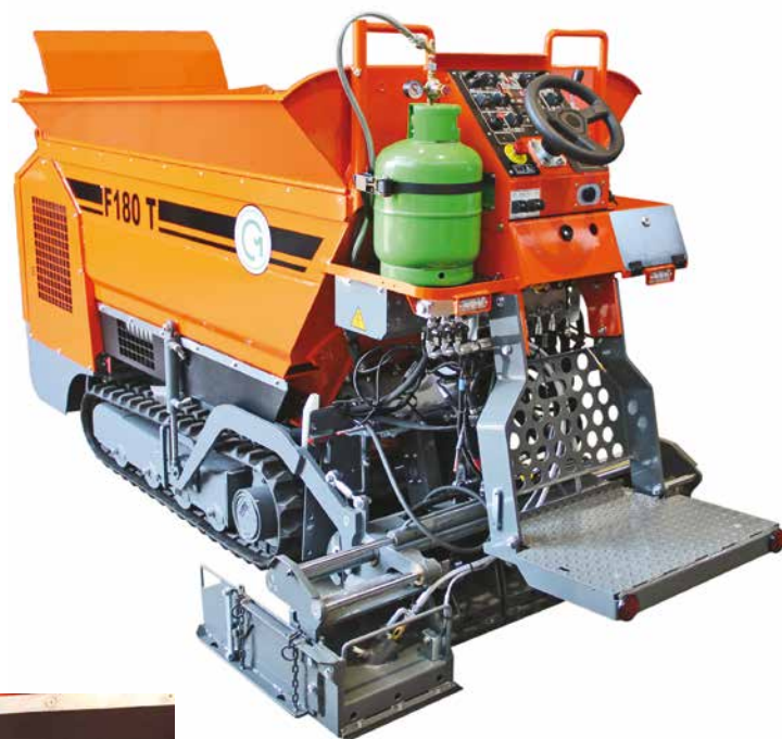
4. La postazione di guida ergonomica consente di avere tutti i comandi a portata di mano
