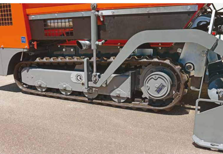
1. La compattezza del carro cingolato è ideale per lavori su tracce molto ristrette, come gli scavi per la fibra ottica
