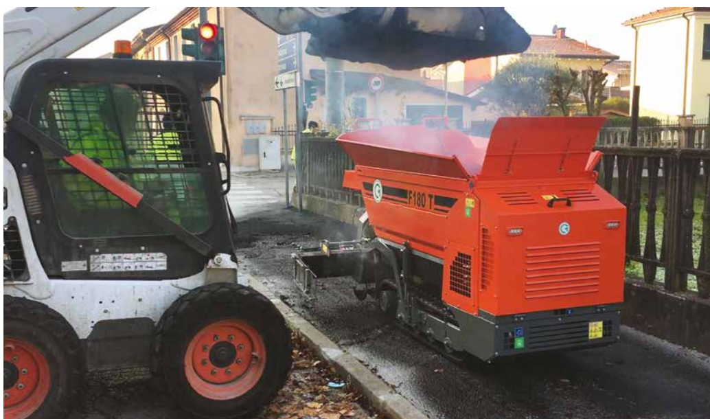
5. Le paratie ribaltabili della tramoggia assicurano un perfetto carico con mini-pala
