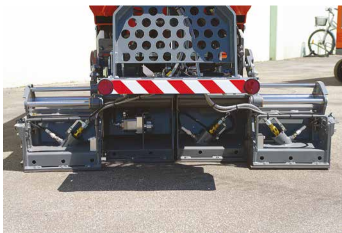
2. Il rasatore S175V, con comando idraulico, si può estendere da 80 a 135 cm
