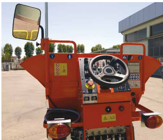
6. Lo specchio retrovisore e catarifrangenti sono alcuni elementi del kit per omologazione stradale
