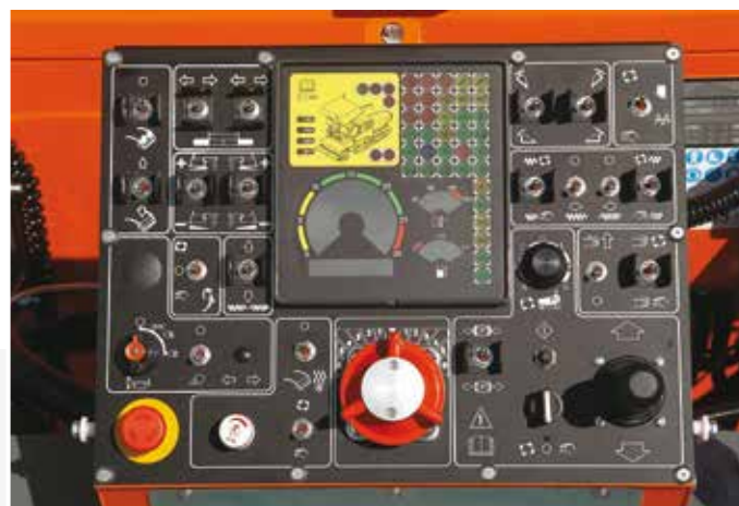
8. Dal pannello comandi, l'operatore ha accesso immediato a tutte le funzioni della macchina
