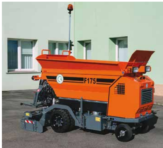
3. Le quattro ruote della F175 aumentano considerevolmente la stabilità e la trazione della macchina
