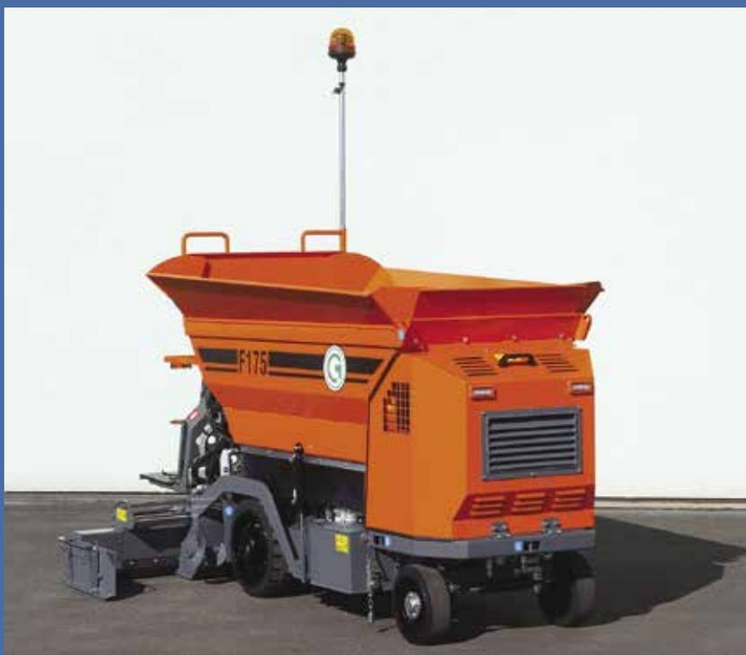
Rexroth, Perkins e Lohmann, oltre a un consolidato sistema di trazione, catene in acciaio e pattini rivestiti in gomma, un cruscotto tecnologico ma intuitivo e di facile manutenzione, due sportelli laterali posti su ciascun lato della macchina e un cofano apribile verso l'alto, diverse configurazioni di rasatore e un motore diesel Perkins da 50 kW.
