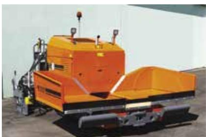
**LA VIBROFINITRICE CM F220T - CHE MONTA CINGOLI CON CATENE IN ACCIAIO E PATTINI RIVESTITI IN GOMMA E UN MOTORE PERKINS DA 50 KW - È DOTATA DI RASATORE ESTENSIBILE CON COMANDI IDRAULICI CON RISCALDAMENTO A GAS O ELETTRICO, FORNITO IN VERSIONE TAMPER O VIBRANTE. IL CRUSCOTTO È ALTAMENTE TECNOLOGICO MA INTUITIVO**
